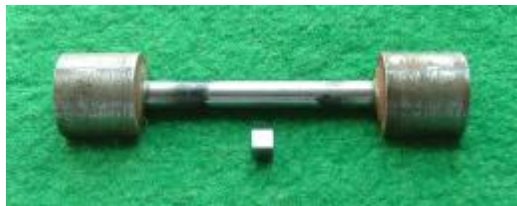
5. ábra Hőfárasztott próbatest és a középső részéből kimunkált kocka alakú minta.
